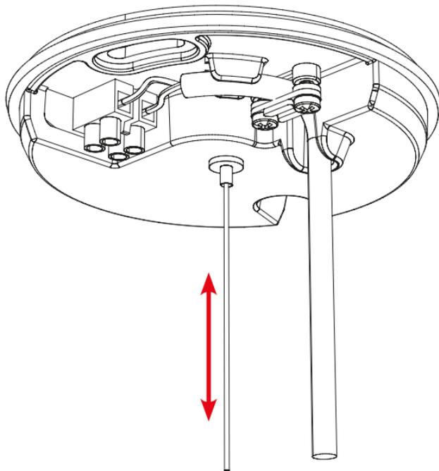
Allentare le viti del bloccacavo (7) al fine di rendere possibile il passaggio del cavo di alimentazione. Inserire i cavi nel morsetto (8) e serrare. Serrare il bloccacavo sulla guaina esterna del cavo. Accostare il rosone (2) alla basetta (1) e premere leggermente fino allo scatto di fissaggio.
