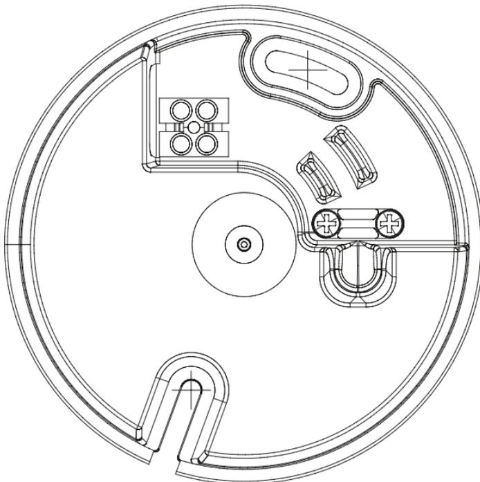
Inserire nel morsetto (8) i cavi di alimentazione provenienti dal soffitto, facendoli passare attraverso l'apposita fessura. Fissare successivamente la basetta al soffitto con i tasselli forniti con la confezione.
