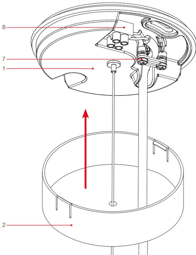
Per centrare la lampada è necessario agire sulla fune metallica della lampada, la quale deve rimanere in tensione rispetto al cavo di alimentazione.
